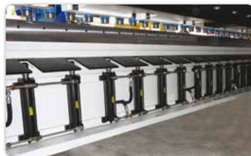
⊕ Sistema antisvergolamento lamiera idraulico Hydraulic anti-twist system
