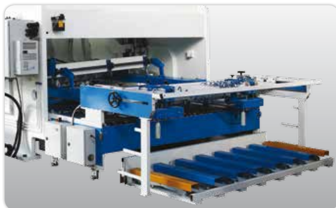
⊕ Evacuatore lamiera con sostentatore ed impilatore automatico. Conveyor with sheet sustainer and automatic stacker.
