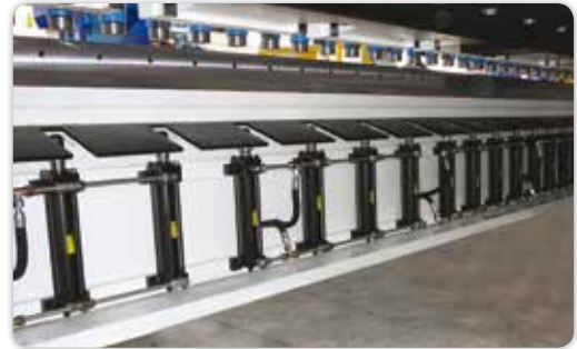
Hydraulisches System gegen Verdrehen des Blechs „anti-twist“ Hydraulic anti-twist system
