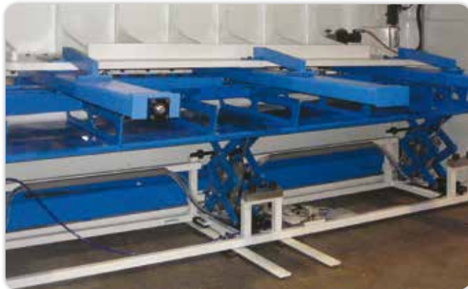
⊕ Zweistufiges Blechhochhaltesystem (Senken und Neigen), sowie die Rückföhrfunktion „Return to Sender Funktion“ mit dieser Funktion werden die geschnittenen Bleche vom Anschlag zuröck auf die Bedienerseite transportiert. Sheet support with double movement (descent and inclination) and special function of return to sender of the piece cut.
